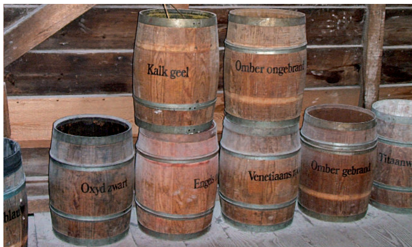
De voorraad tonnen met daarin verfpoeder in verschillende kleuren om verf van te maken. Verfmolen De Kat in de Zaanse Schans (foto: J. Zondervan-van Heck).
