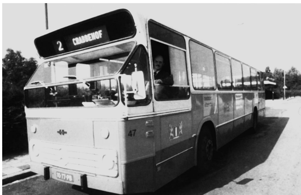
Afb. 5.15 Een bus Mercedes O 305/Hainje van lijn 2 vertrekt omstreeks 1975 van het Van der Steenhovenplein bij ziekenhuis Refaja in Wielwijk. De bestemming Crabbehof wordt bereikt via het centrum, Dubbeldam en Sterrenburg. Van de 54 bussen van deze serie kregen er 26 een opbouw van Hainje. Deze opbouw was dezelfde als die van de standaard-stadslinbussen op een DAF-chassis, die elders in het land reden, (fotoarchief S.V.D.).
