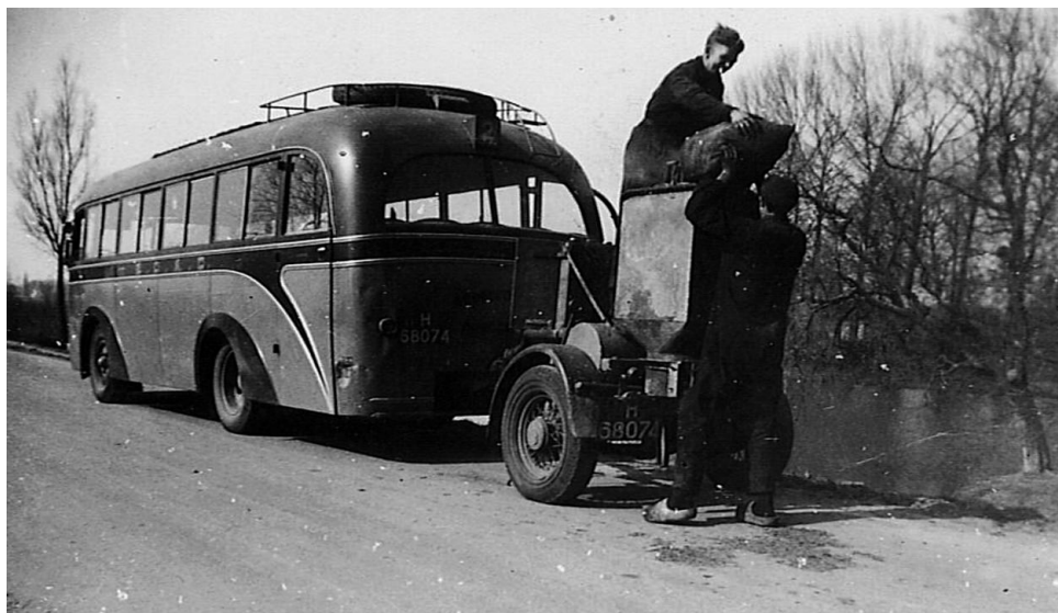
Afb. 4.32 De houtgenerator wordt in 1941 aan het eindpunt van lijn 2 op de Staart bijgevuld met blokjes hout, (V.I.O.S.-E.D.A.D. 4, Ford/Verheul, bouwj. 1939, 33 zitpl.). (fotocollectie W. Geense)
