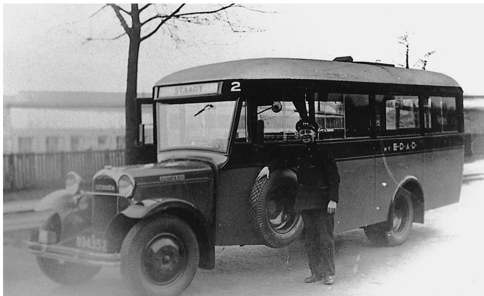
Afb. 4.28 Een E.D.A.D.-bus (Citroën/Verheul, bouwj. 1931, 23 zitpl.) in 1932 aan het eindpunt van lijn 2 op de Staart. Samen met vier soortgenoten werd deze wagen in 1935 voorzien van een dieselmotor met een uitlaat op het dak. De Dordtenaren spraken dan ook over de 'stoomboten', (fotocollectie W. Geense).
