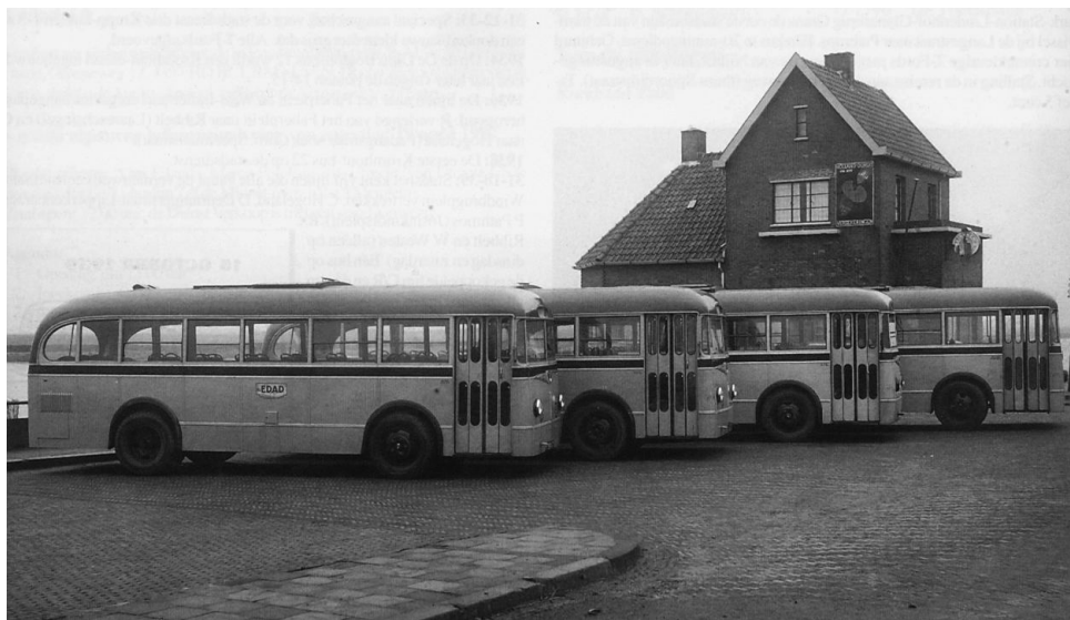
Afb. 4.39 De laatste serie stadslijnbussen door de E.D.A.D. besteld, staat opgesteld bij het veer in Wieldrecht in 1948. Ze deden tot en met 1956 dienst op de E.D.A.D.-lijnen. Deze Ford-bussen hadden de motor achterin. Let op de vouwdeuren, die al vlak vóór de oorlog steeds meer werden toegepast, (V.I.O.S.-E.D.A.D. 22, 24, 35 en 36, Ford Transit/Verheul, bouwj. 1948, 33 zitpl.), (fotocollectie S.A.D.).
