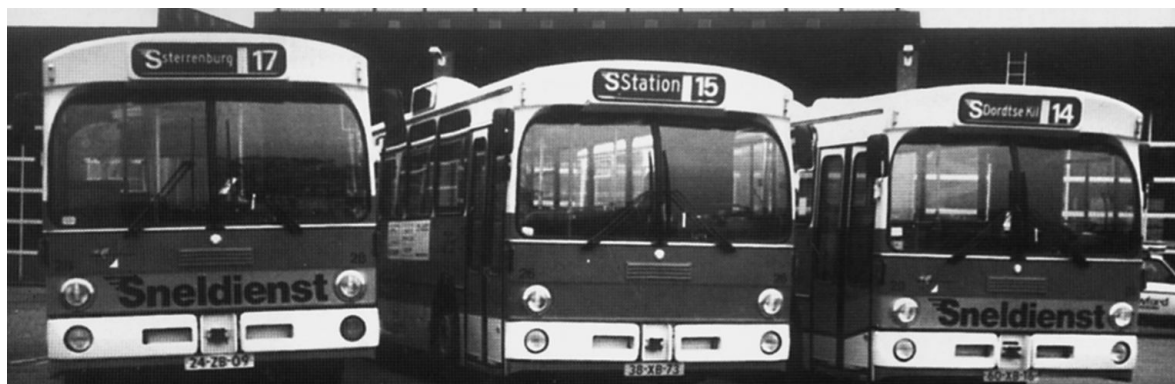
Afb. 5.21 In 1990 deden op de drie sneldiensten 14, 15 en 17 bussen van het type O 305 dienst. Met 54 exemplaren was de O 305 de grootste serie Dordtse stadsbussen. De bussen op de foto werden in 1980 compleet met opbouw geleverd door de autobusfabriek van Mercedes in Mannheim en ze behoorden daarmee tot de tweede groep uit deze serie die met de bijnaam 'Mannheimer' werd aangeduid, (fotoarchief S.V.D.).
